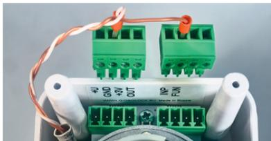
Фото 24. Подключение проводного выключателя
