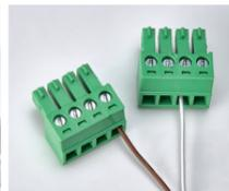
Фото 14. Подключение провода датчика к ответной части разъема
