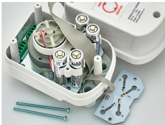
Фото 17. Контактная площадка снята, батарейки могут быть заменены
