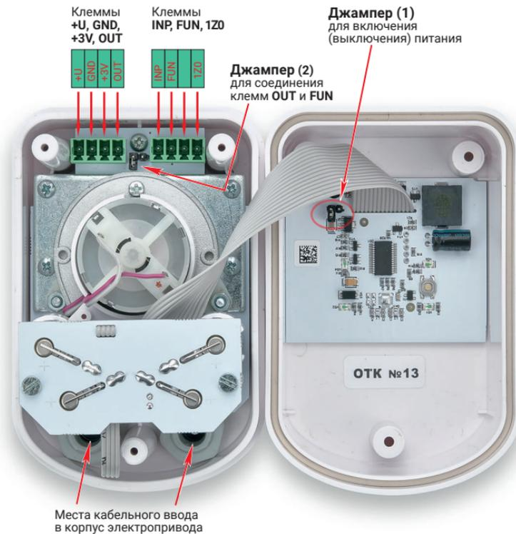
Фото 7. Электропривод управления шаровым краном со снятой крышкой
