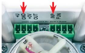
Фото 13. Клеммы подключения проводных датчиков — INP, GND
